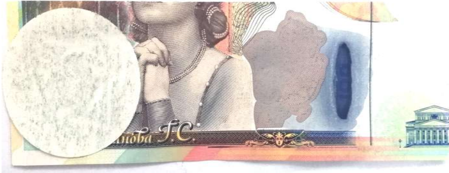
شكل ( ١٨ ) ثبات عنصر HMC و ثبات خصائصه التآمينية بعد اجراء التجربة
