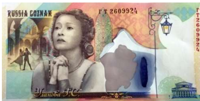
شكل ( ١٦ ) عينة تحتوي على عنصر HMC صورة كامنة متعددة الالوان
