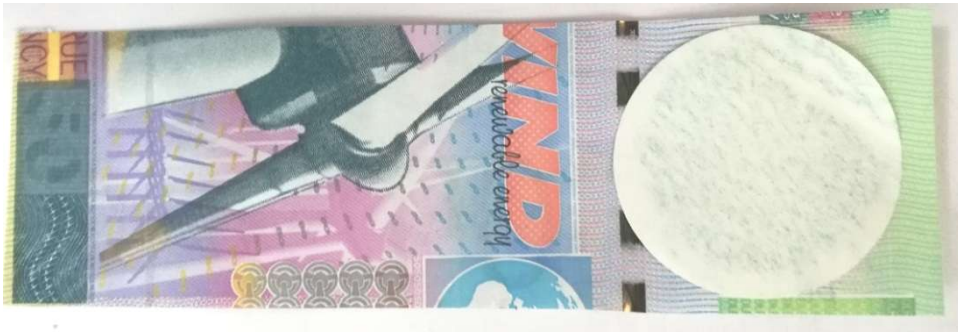
شكل ( ٢٠ ) تاثر بسيط لعنصر الصورة الكامنة التقليدية المطبوع بطباعة الانتاليو لا يؤثر على خصائصها التامينية وفعاليتها
