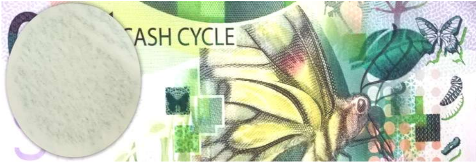
شكل ( ١٧ ) ثبات احبار OVMI الحديثة و ثبات خصائصها التآمينية بعد اجراء التجربة
