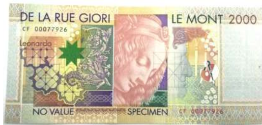
شكل ( ١٣ ) عينة تحتوي على احبار OVI التقليدية مطبوعة بالطباعة المسامية
